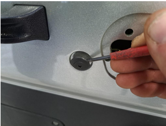
Raota kiinnitysklipsua (pieni talttameisseli) ja irrota kiinnitysklipsu. (muovinen sorkkarauta).
