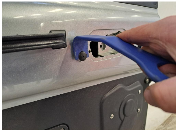
Raota kiinnitysklipsua (pieni talttameisseli) ja irrota kiinnitysklipsu. (muovinen sorkkarauta).
