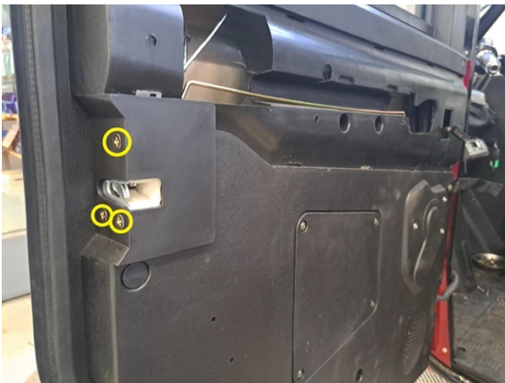
Irrota lukon kiinnitysruuvit. (ristipäämeisseli ph2).
